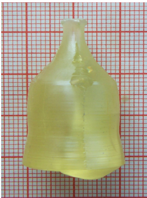
Fig. 1. \text{Dy}^{3+}:\text{Li}_2\text{Gd}_4(\text{MoO}_4)_7 crystal grown by the Czochralski method.
